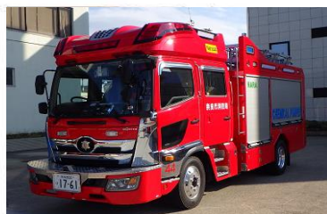
化学車 ガソリンや灯油などの油火災に 出動します。
