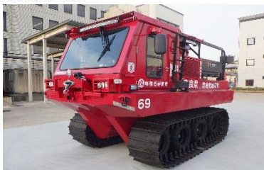
中型水陸両用車 大雨や洪水などで、道路が水に かり他の消防車が入れない場所 で人を助けます。
