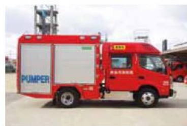
しや ポンプ車 しょうかせん いけ かわ みず す 消火栓や池・川などの水を吸い あ しょうか 上げて消火します。
