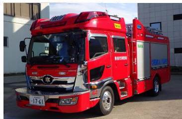
かがくしゃ 化学車 ガスリンや灯油などの油火災に しゅつどう 出動します。
