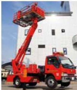
こうしよきゆうじよほうすいしゃ 高所救助放水車 15メートルまでのび多くのひと を一度に助けたり、水を出して しょうか 消火します。
