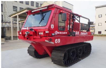
ちゆうがたすいりくりようようしゃ 中型水陸両用車 おおあめ 大雨や洪水などで、道路が水につ かり他の消防車が入れない場所 は で 人を助けます。
