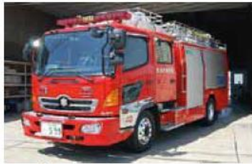
すいそうつき 水槽付ポンプ車 つ 積んでいる水槽の水を使って しょうか 消火します。
