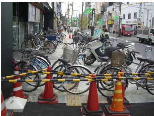
○視覚障害者誘導用ブロック上に障害物がある
