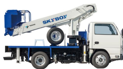
使用機器（高所作業車 12mクラス）
