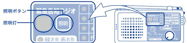
※専用 AC/DC アダプタがコンセントから抜けるなどして、乾電池動作に切り替わると、照明灯が自動的に5分間点灯します。
