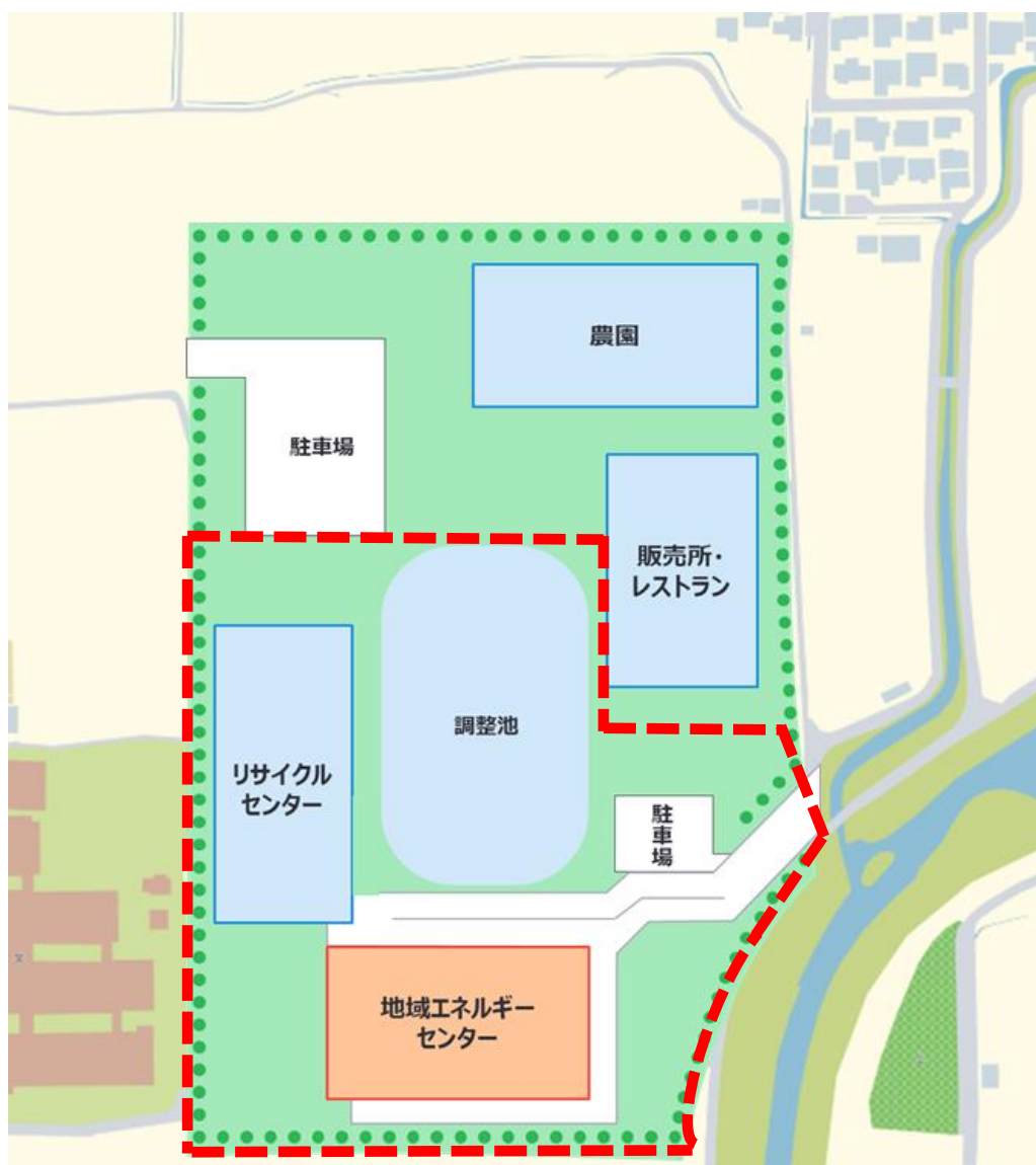
図 15-1 新クリーンセンター施設全体配置計画図（案）
