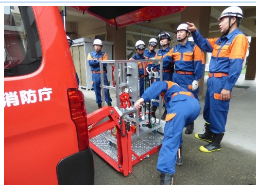
車両後方に装備された電動リフト
