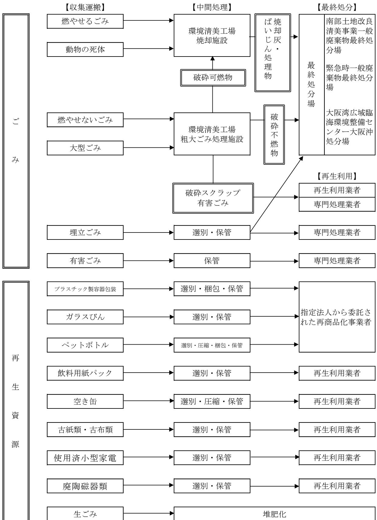
※注 中間処理の選別において生じた残さは、その性状に応じて、焼却、破碎、直接埋立の処理をする。
