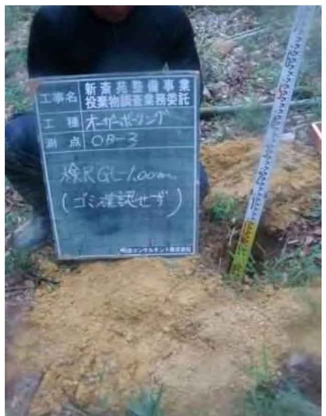
検尺 (掘削深度1.0m)
