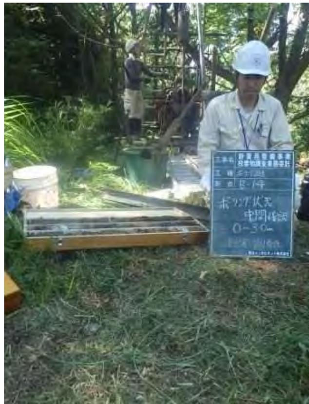
ボーリング状況中間確認(3m掘削時点)
