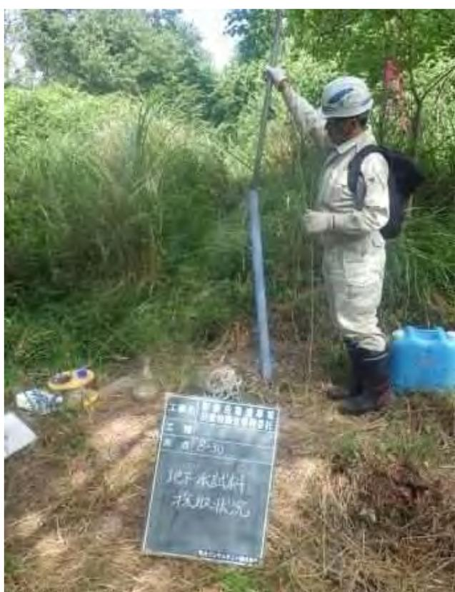
地下水試料採水状況
