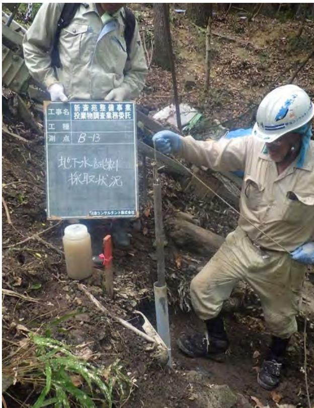
地下水試料採水状況
