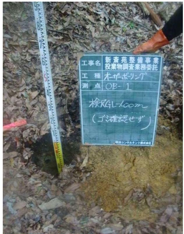
検尺 (掘削深度1.0m)
