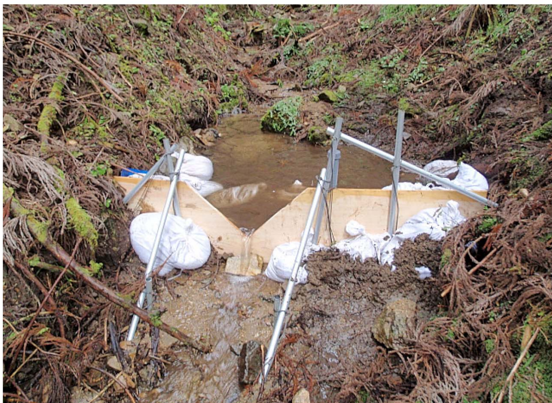
○堰を用いた流量観測実施例
