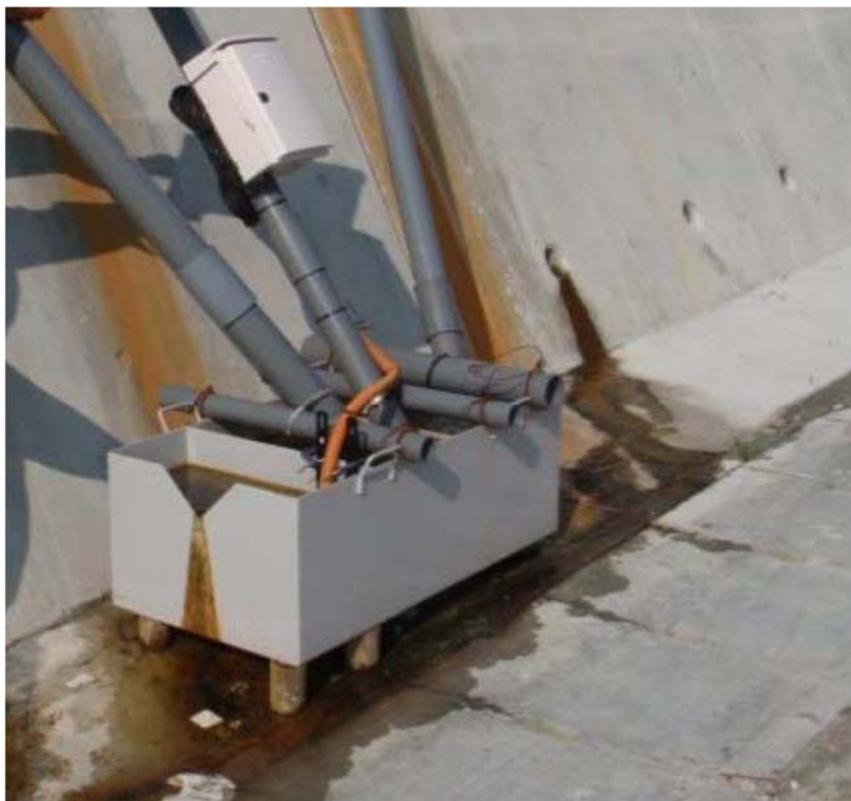
○堰を用いた流量観測実施例
