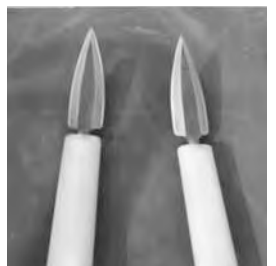
解体修理で使われる槍鉋
