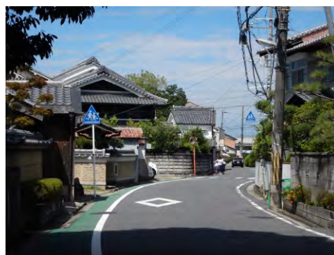
水路を暗渠にして拡幅した道路
