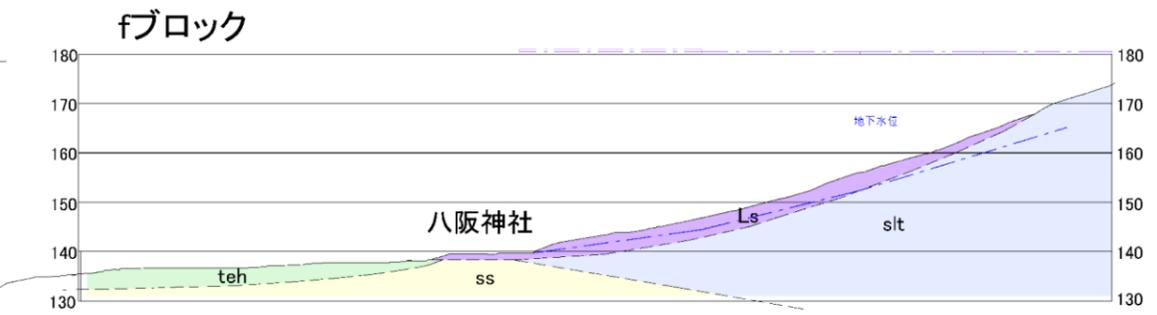
各地すべりブロックの断面図（縦横比 1 : 1）
