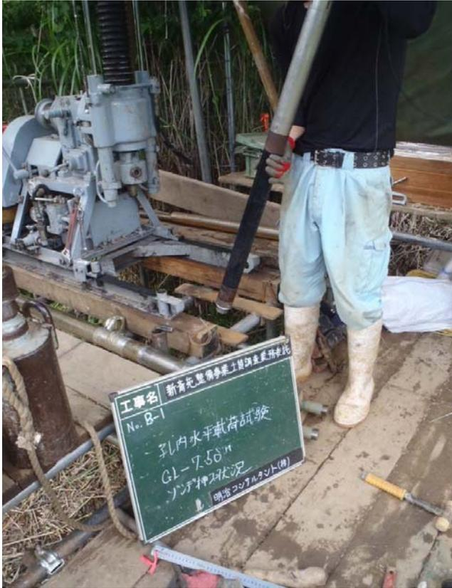
孔内水平載荷試験GL-7.5m(ゾンデ挿入)
