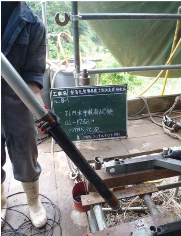
孔内水平載荷試験GL-18.5m(ゾンデ挿入)
