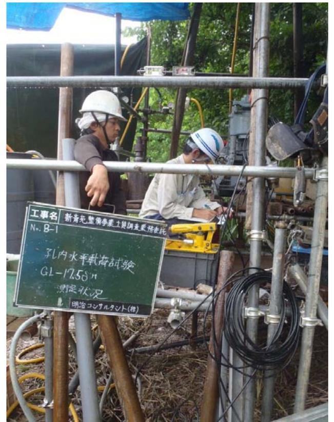
孔内水平載荷試験GL-18.5m(測定状況)
