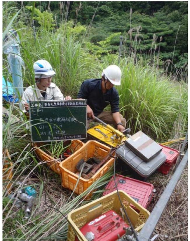
孔内水平載荷試験GL-7.5m(測定状況)
