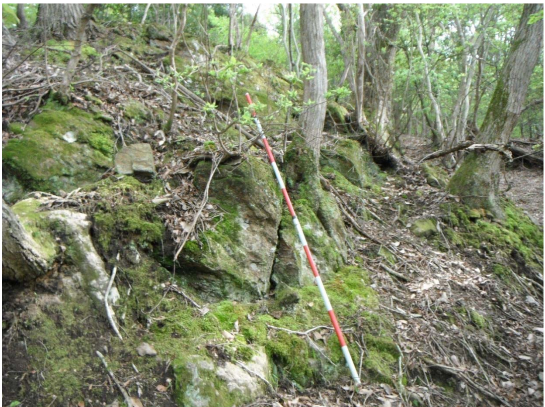
P-64 : 節理面の発達した塊状の片麻岩。CM 級。
