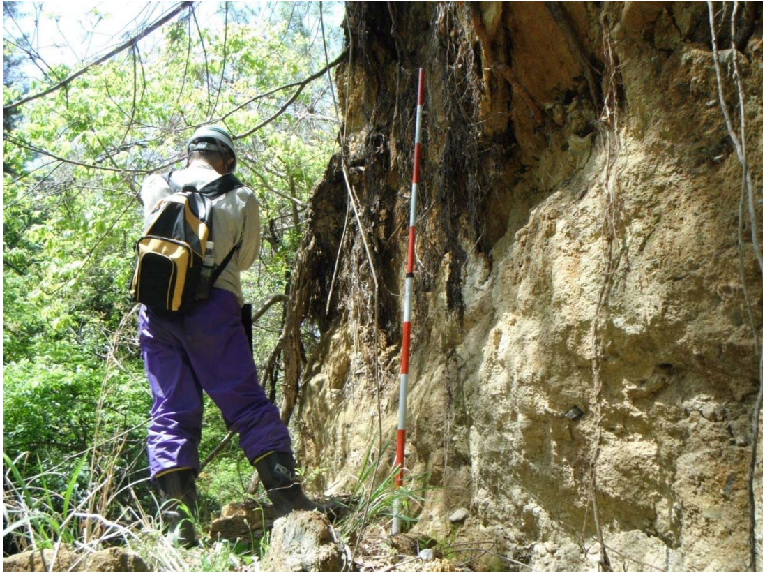
P-41 : 礫岩は CL-DH。風化が進んでおりハンマー打撃により容易に碎ける。
