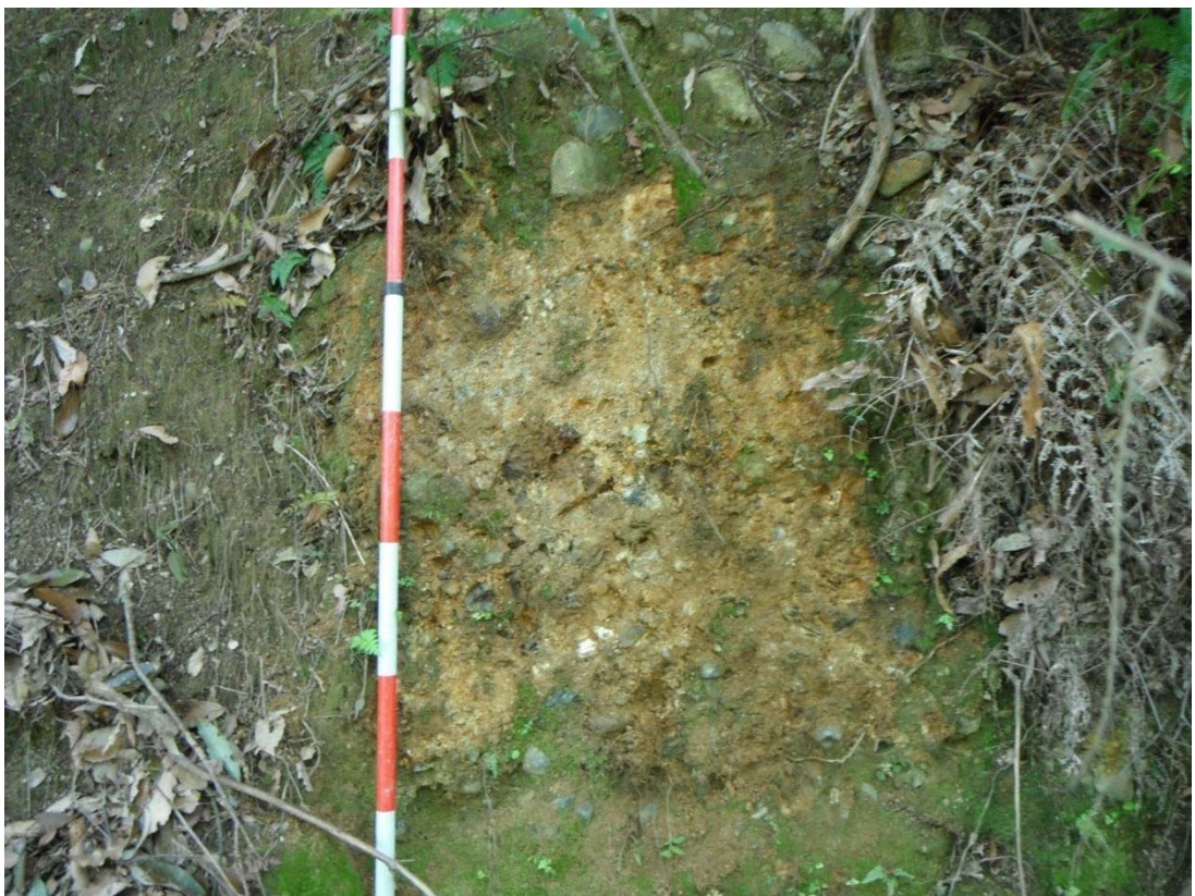
P-46 : 礫岩。φ10cm 程までの硬質な礫を混入する。基質は風化による土砂化が進んでおり、容易に削れる。DH。
