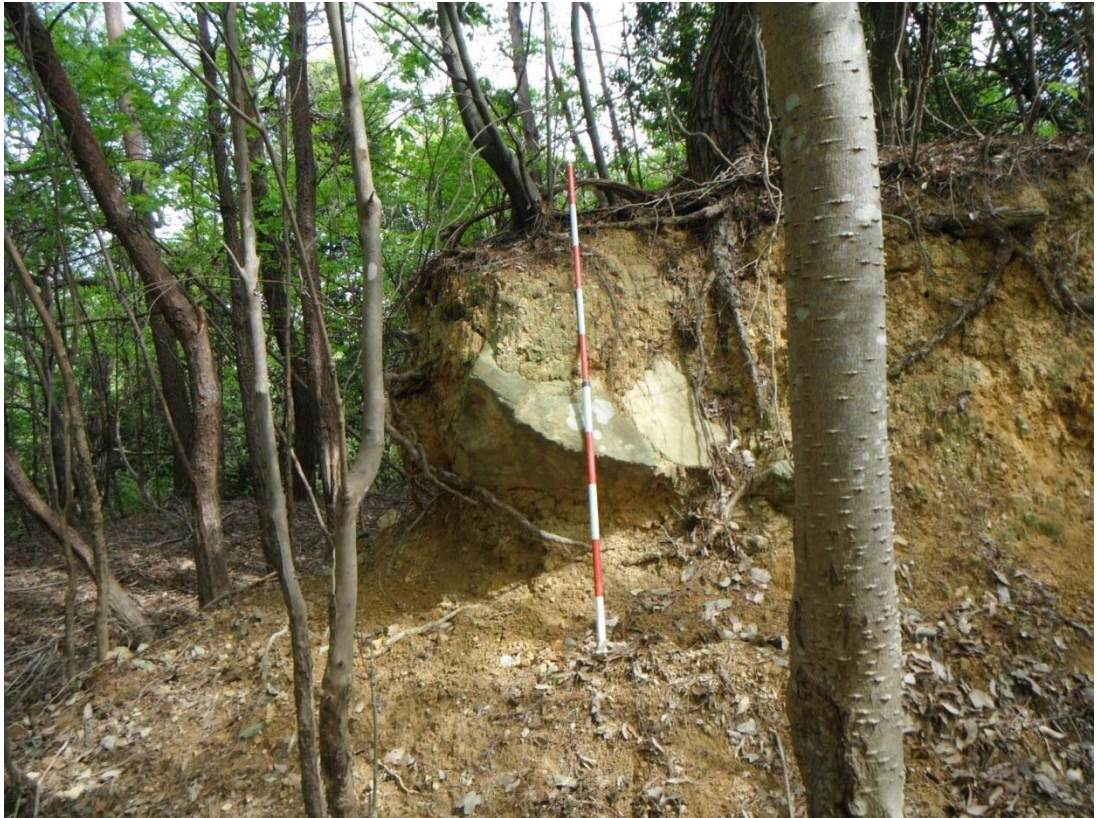
P-55 : CM の硬質な礫岩。露頭から分離しつつある。
