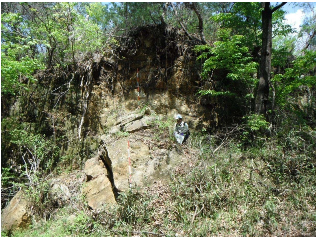
P-40 : 礫岩の大露頭。CL-DH。下段ポール下方にたまっている岩塊は、後背から分離・落下したもの。
