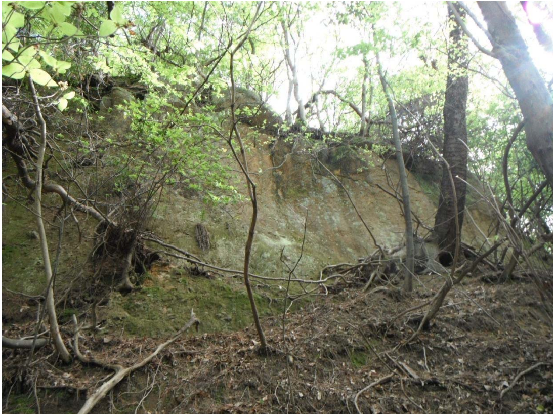
P-59 : 直壁状の露頭。礫岩。岩級は CM-CL。
