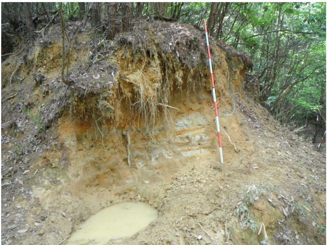
P-52 : シルト岩。固結度が低く、容易に崩れる。DH。
