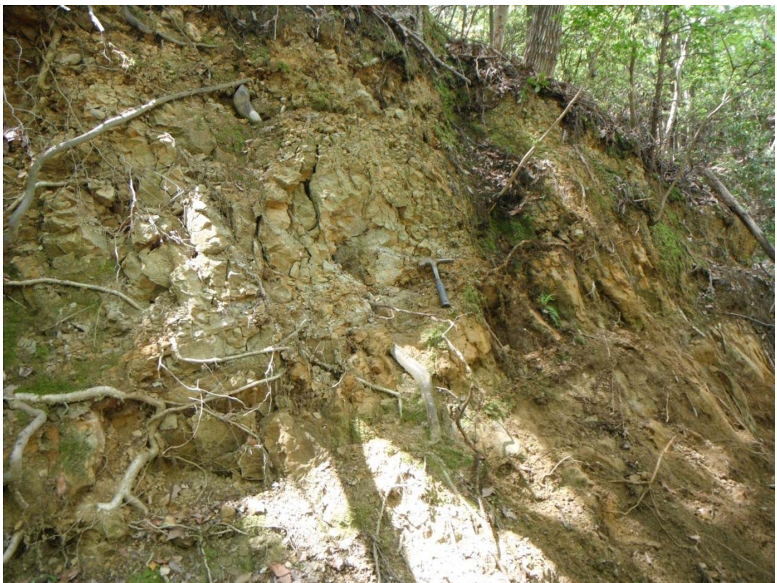
P-48 : シルト岩の露頭。低角な層理面がある。N50E 8S。シルト岩は固結度が低く、容易に崩れる。DH。
