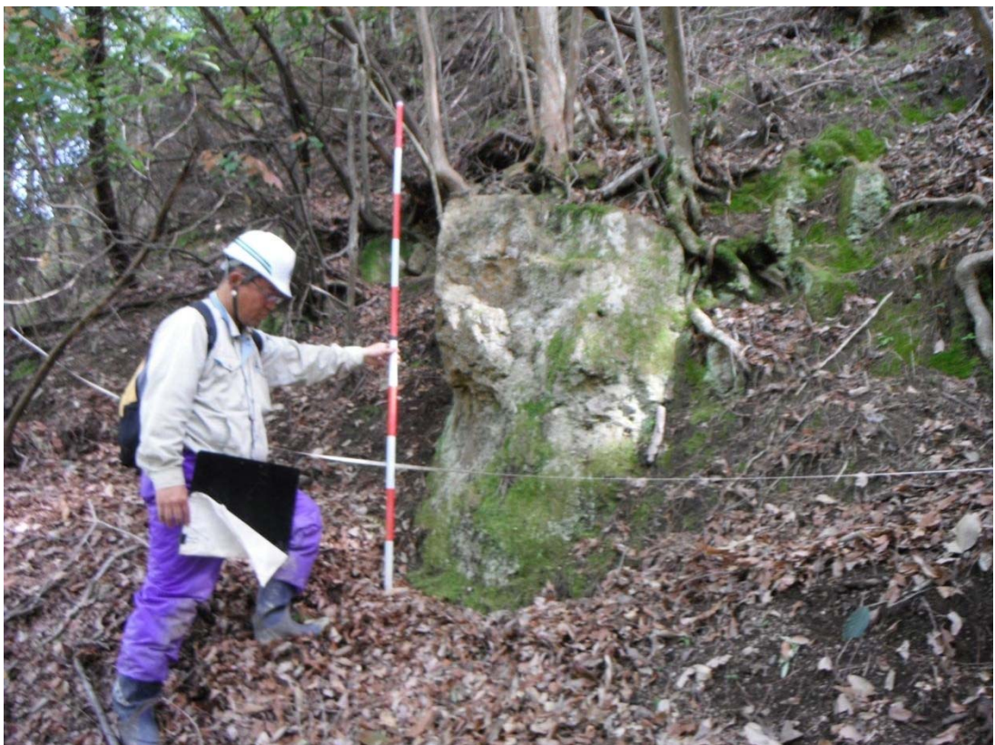
P-58 : 直壁状の露頭から落下したと思われる転石。1.8m×1.2m 程度。CM。転石の数自体は少ない。
