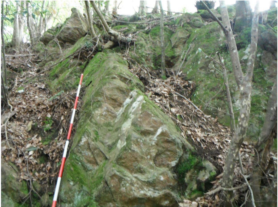
P-65 : 節理面の発達した塊状の片麻岩。珪質で硬質である。CM 級。節理面は N40W 70S、N80E 52N、N35E 60S。
