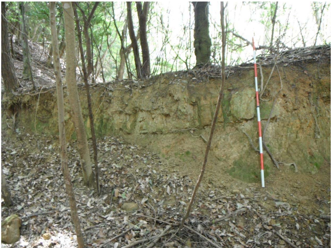
P-54 : シルトと砂の中間的な岩。低角な層理面がある。
