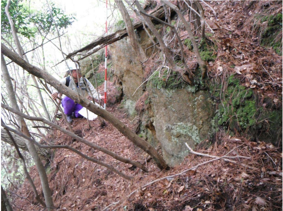
P-33 : 高さ 2m 超の礫岩の露頭。岩は比較的硬く CM 程度である。
