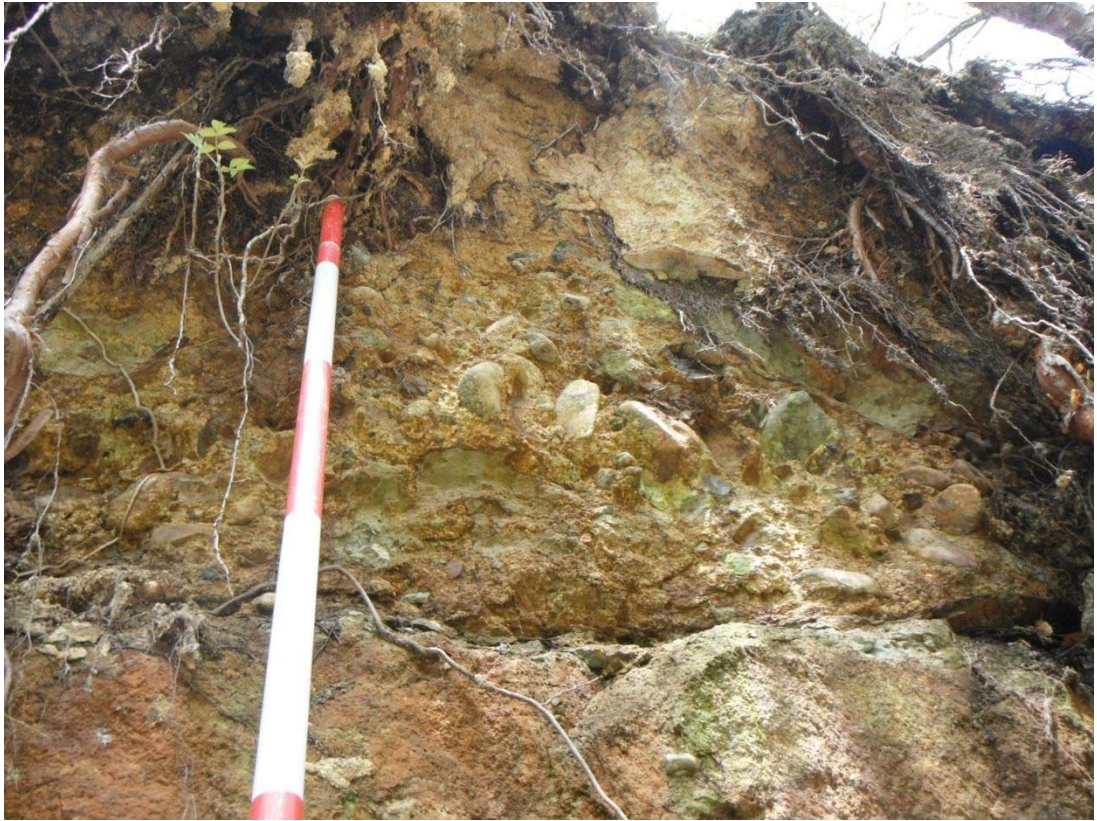
P-43 : 露頭の上層。φ10cm 程度までの円摩した礫が多く混入する。
