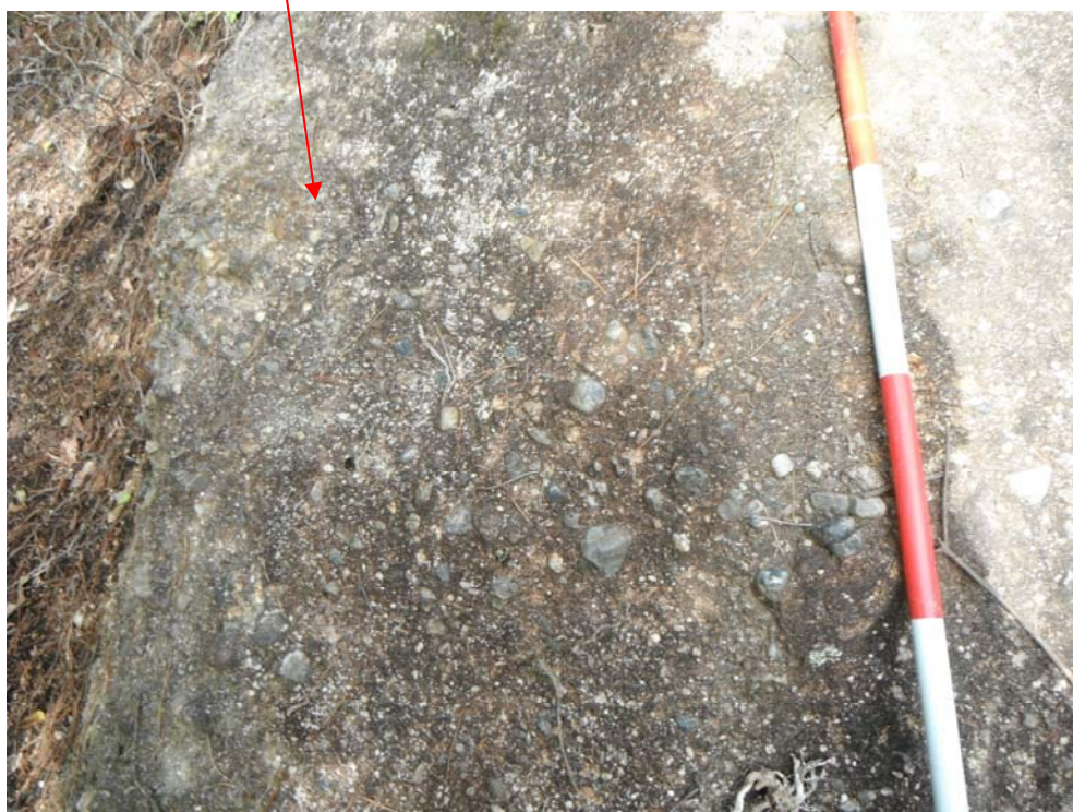
写真-4；尾根筋に露出した礫岩。CL-CM。礫は硬質だが基質部のほうは若干軟く、ハンマーでわずかに削ることができる。(P-22)
