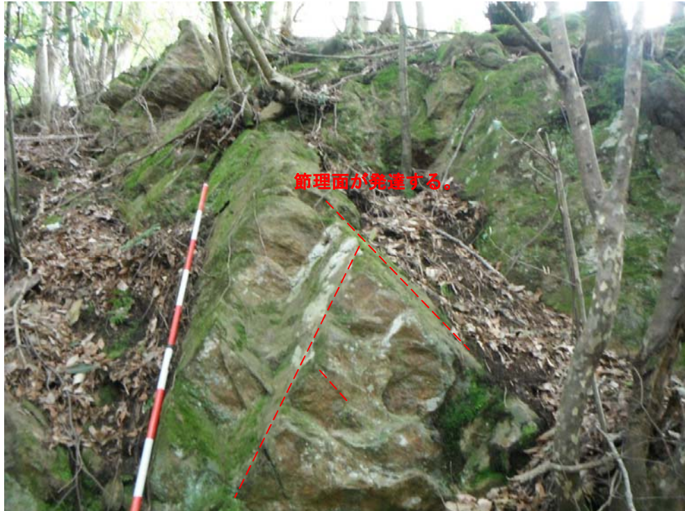
写真-5；節理面の発達した塊状の片麻岩。珪質で硬質である。CM 級。節理面は N40W 70S、N80E 52N、N35E 60S。(P-65)
