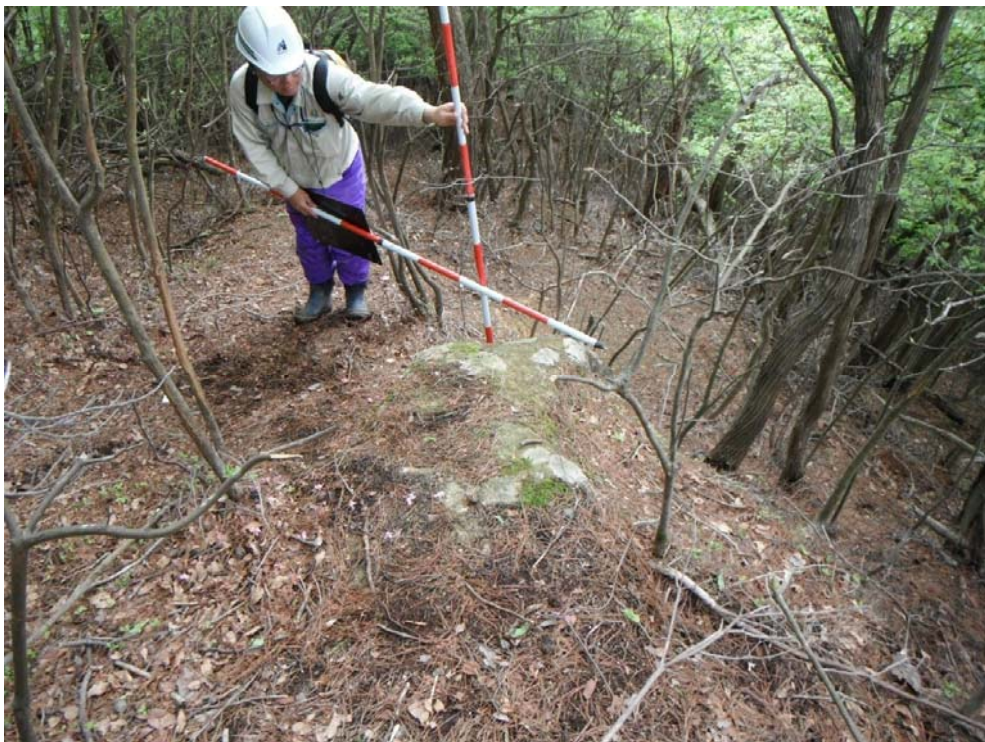
写真-10；尾根筋に露出する礫岩。CL-CM。尾根部は形状がしっかりしており、基盤岩は浅部から分布する。(P-29)
