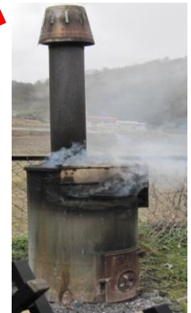
法に定められた基準を満たさない焼却炉
