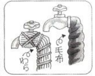
わら、毛布、布などを巻き、ビニールなどで覆い保温材がぬれないようにする。
