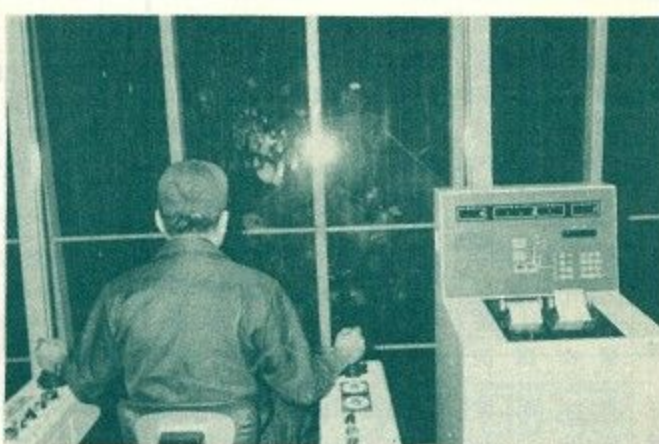
ゴミを焼却炉に入れるクレーンは一度に1.75トンもつかめ、右側の計器がその量などを記録している
