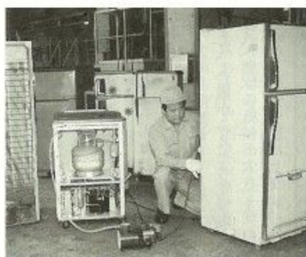
環境清美工場でのフロンガス回収作業
