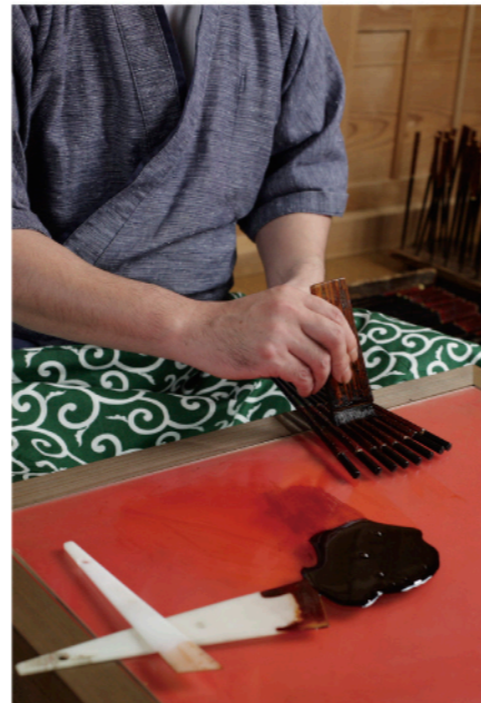
若狭塗箸生産日本一 匠が何度も塗り重ねた漆を磨いて生み出す若狭塗は伝統の技の美しさ。
