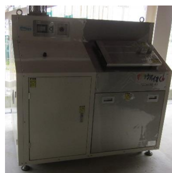
生ごみ処理機 (平城中学校)
