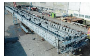
橋梁上部工 工場検査（橋桁仮組立）
