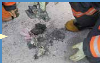
ごみ収集中に発火した小型二次電池
