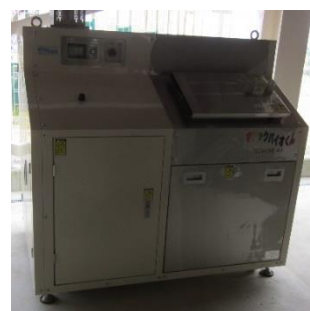
生ごみ処理機（平城中学校）
